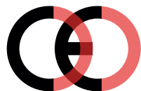
Falsk CE-mærke (for tæt på hinanden)
